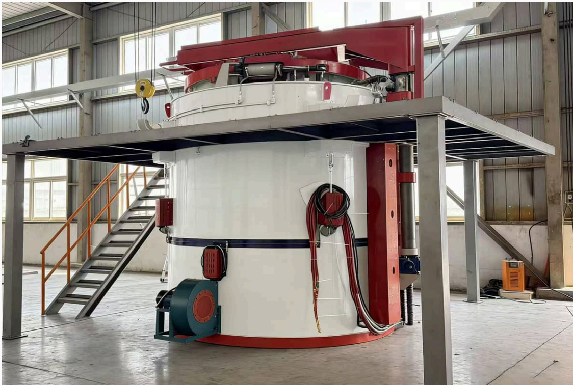
株洲远航工业炉科技有限公司 - 珠宝首饰光亮退火炉设备实物图
