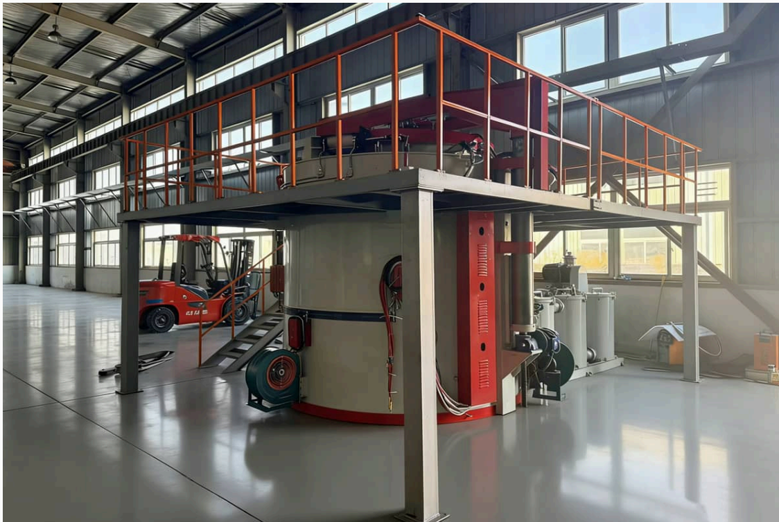
株洲远航工业炉科技有限公司 - 高强钢回火炉设备实物图
