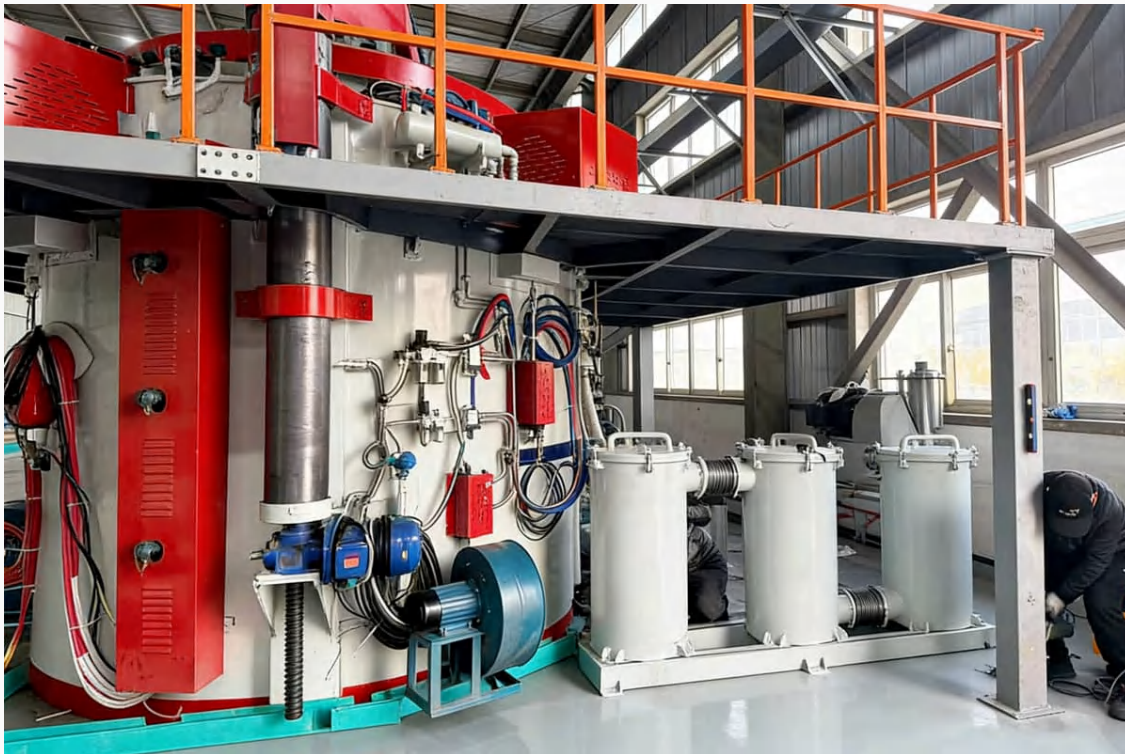
株洲远航工业炉科技有限公司 - 石墨片（PI膜）碳化炉设备实物图
