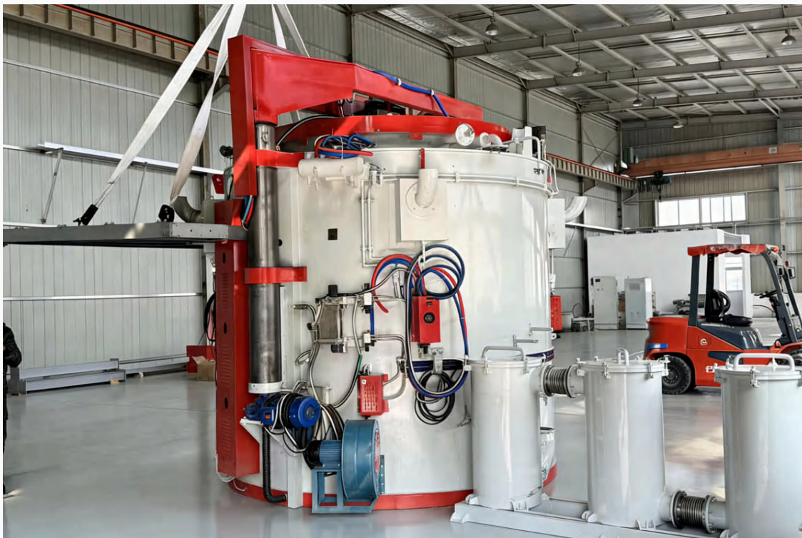
株洲远航工业炉科技有限公司 - 锂电负极预碳化炉设备实物图
