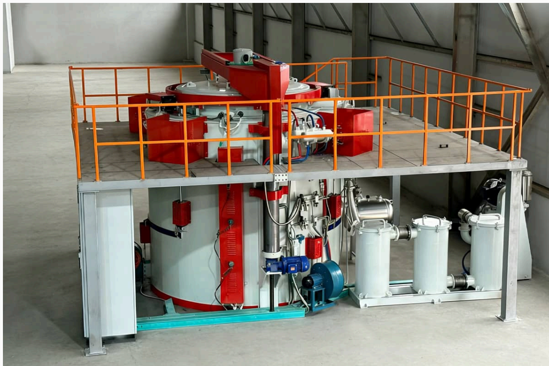
株洲远航工业炉科技有限公司 - 电磁纯铁 (DT4C) 脱气炉设备实物图
