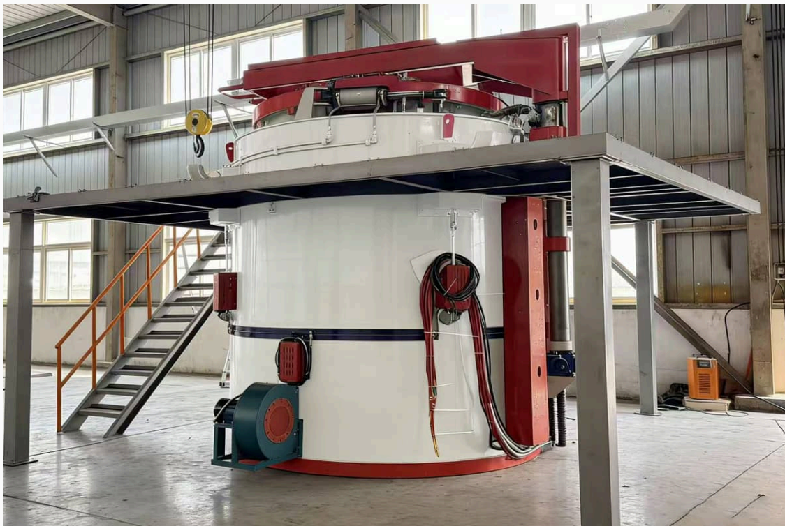
株洲远航工业炉科技有限公司 - 坡莫合金/1J79氢气退火炉设备实物图
