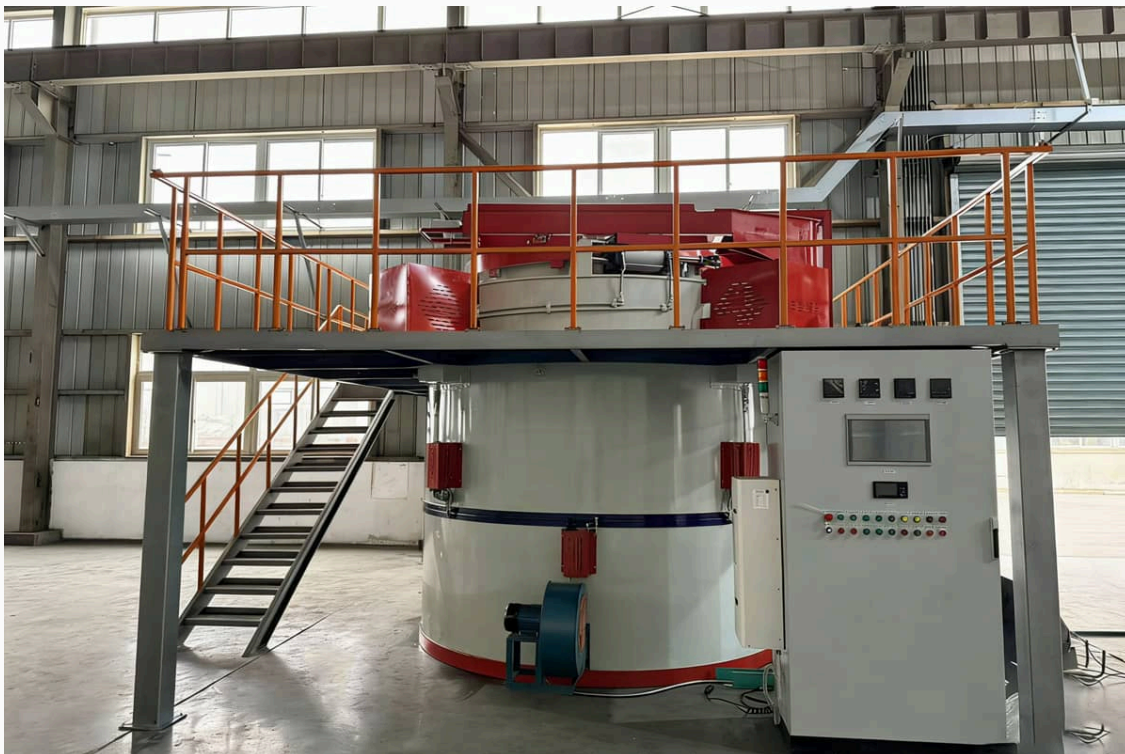
株洲远航工业炉科技有限公司 - 304/316L 不锈钢光亮退火炉设备实物图
