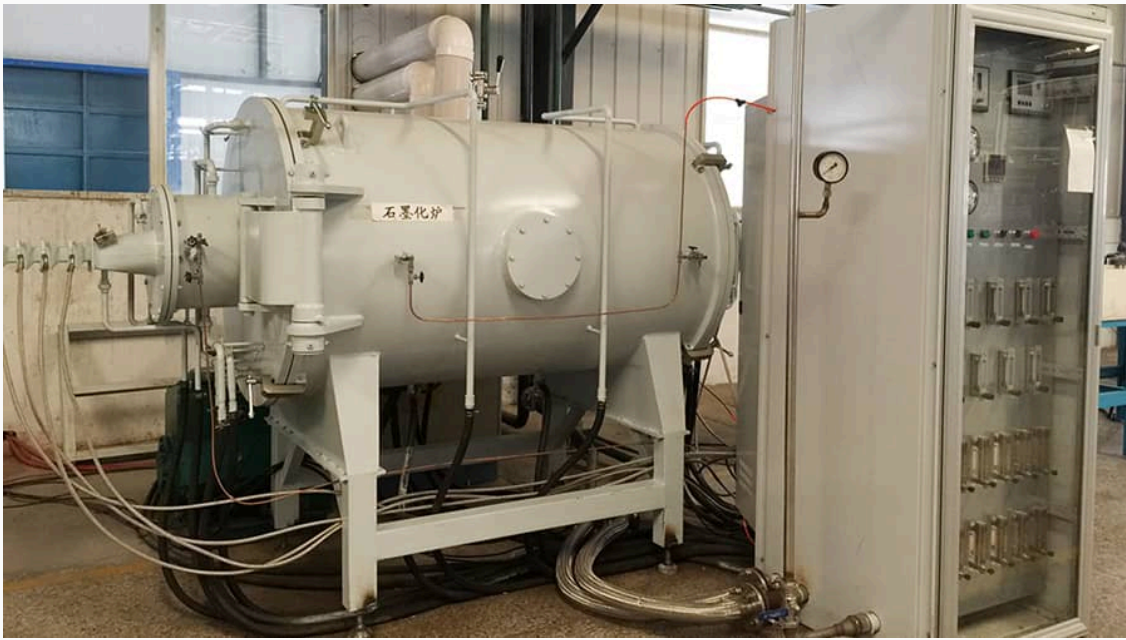
株洲远航工业炉科技有限公司 - 石墨烯石墨化炉设备实物图
