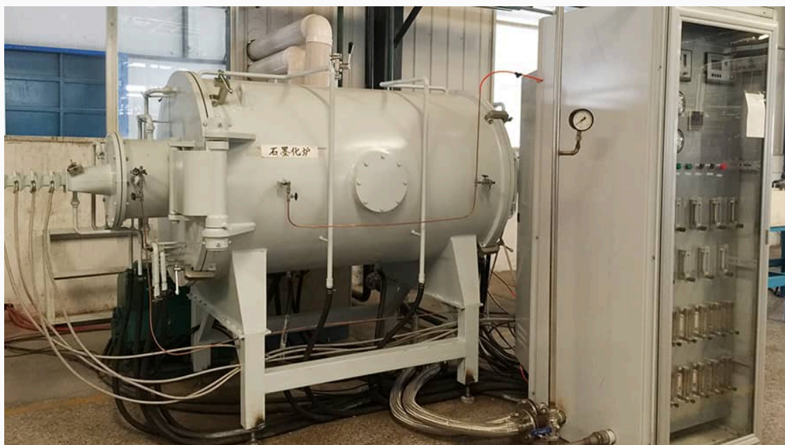
株洲远航工业炉科技有限公司 - 小型实验型石墨化炉设备实物图
