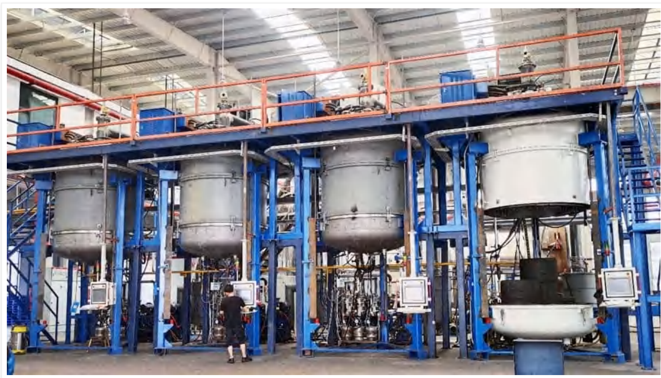
图：远航工业炉-底装料多工位CVD沉积系统（支持多尺寸定制）
