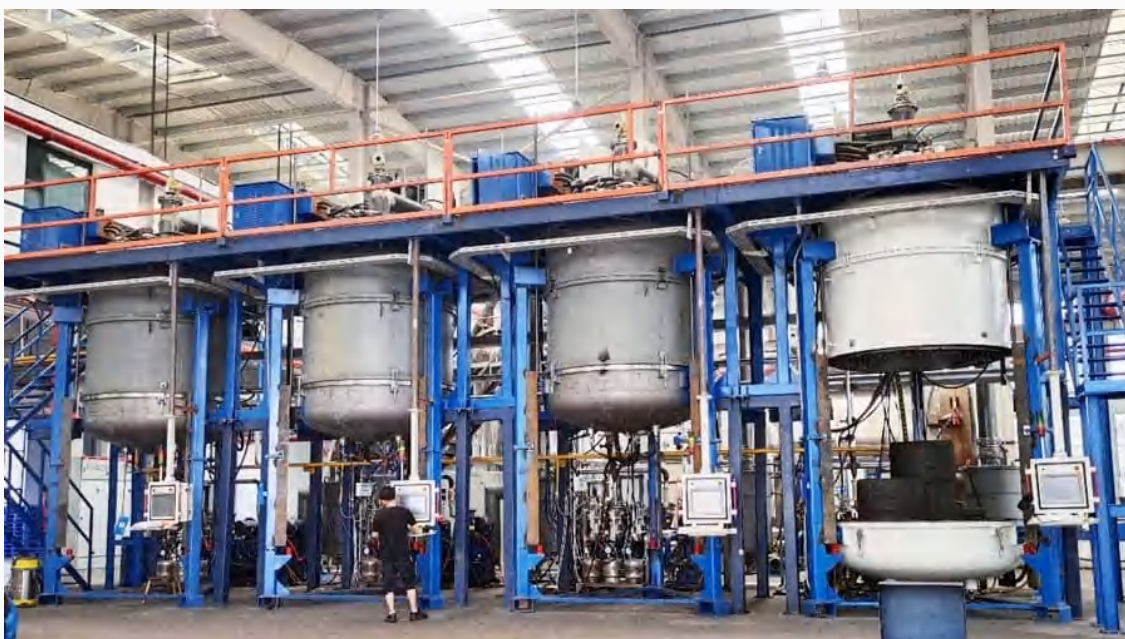
株洲远航工业炉科技有限公司 - 底装料多工位气相沉积炉设备实物图
