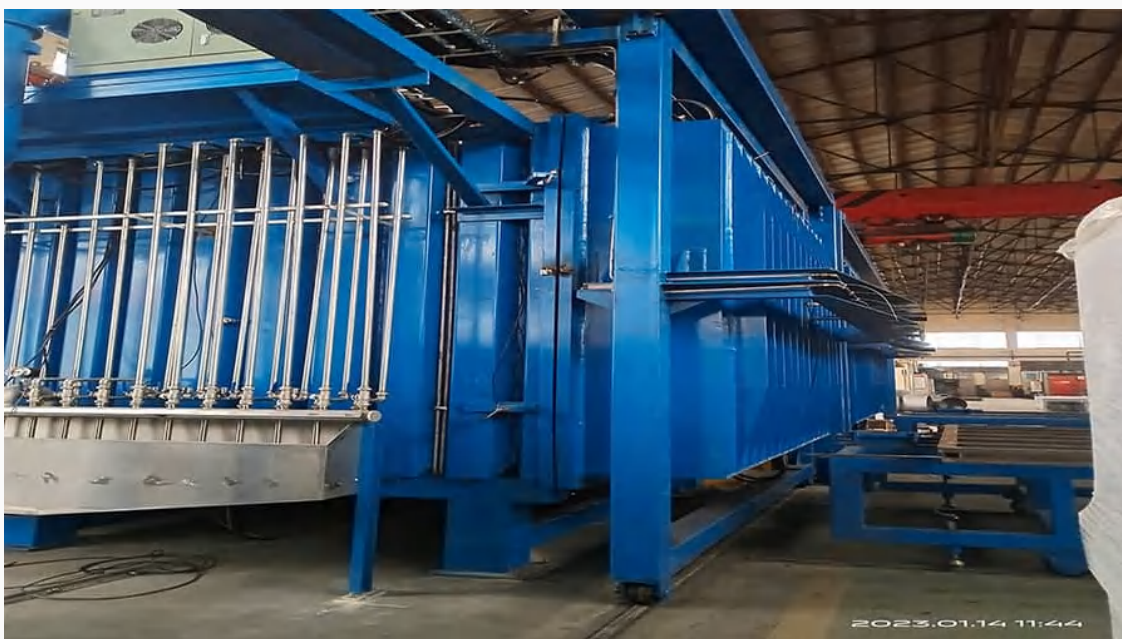
株洲远航工业炉科技有限公司 - 大型卧式方形CVD气相沉积/高温炉设备实物图
