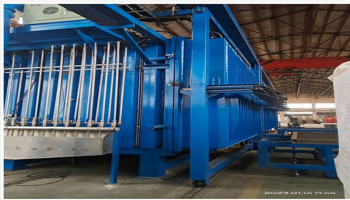
图：远航工业炉-大型卧式方形CVD设备现场（可根据需求定制尺寸）
