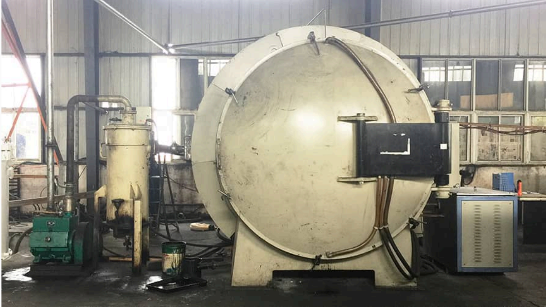
株洲远航工业炉科技有限公司 - 碳化硅烧结炉设备实物图
