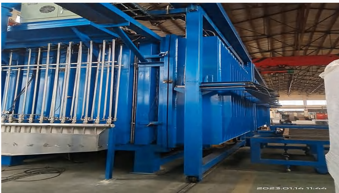
株洲远航工业炉科技有限公司 - 碳陶熔融渗硅炉设备实物图
