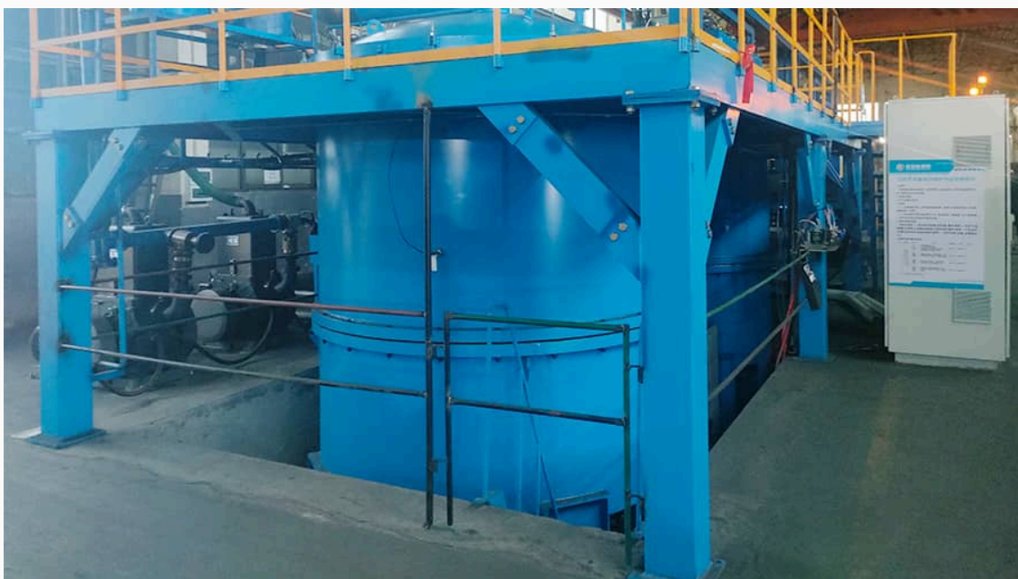
株洲远航工业炉科技有限公司 - 碳陶PIP烧结炉设备实物图
