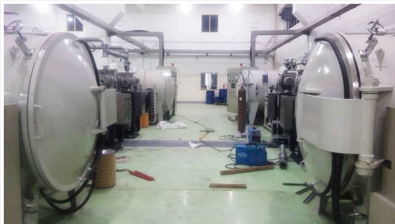
图：远航工业炉-无压烧结炉（支持真空/分压/正压工艺）
