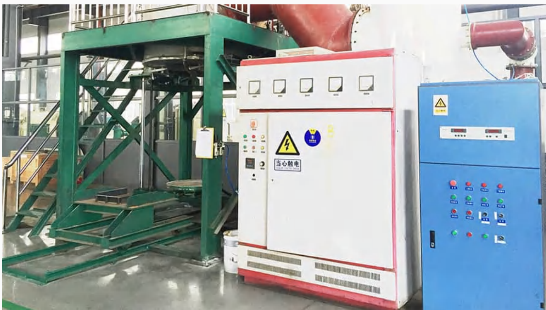
株洲远航工业炉科技有限公司 - 燃料电池用碳纸碳布的碳化石墨化一体化实验炉设备实物图
