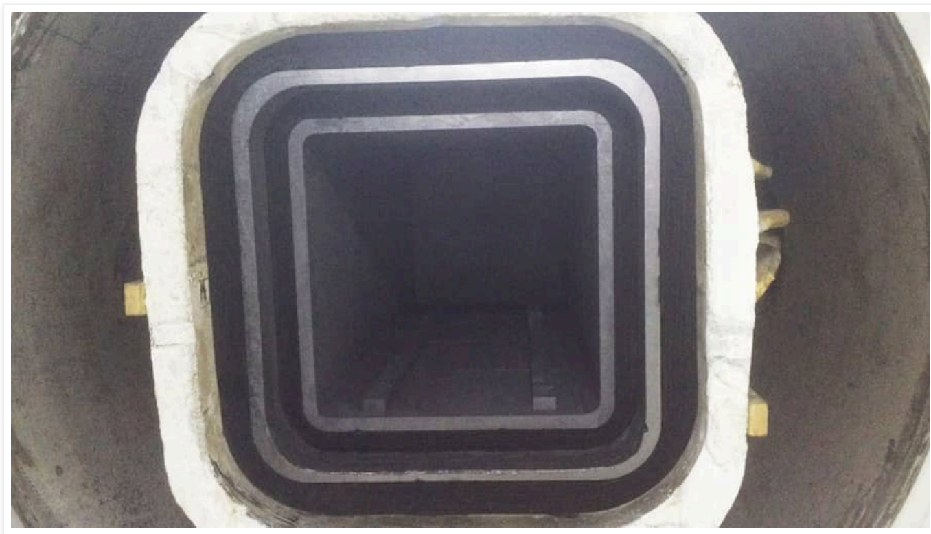
图：远航工业炉-方形卧式石墨化炉（解决方形物料装载难题）
