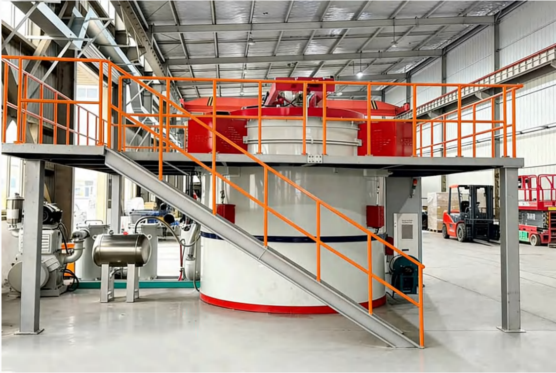
株洲远航工业炉科技有限公司 - VC超薄液冷散热板专用连续式钎焊烧结炉设备实物图
