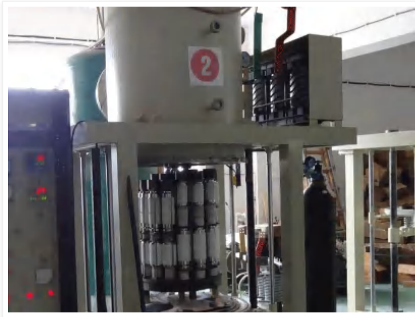
图：远航工业炉-立式单室高真空钎焊系统
