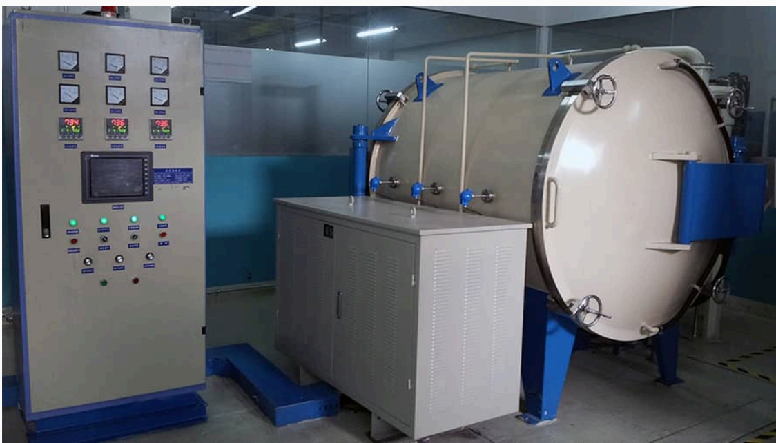
株洲远航工业炉科技有限公司 - 高真空高温碳化炉设备实物图
