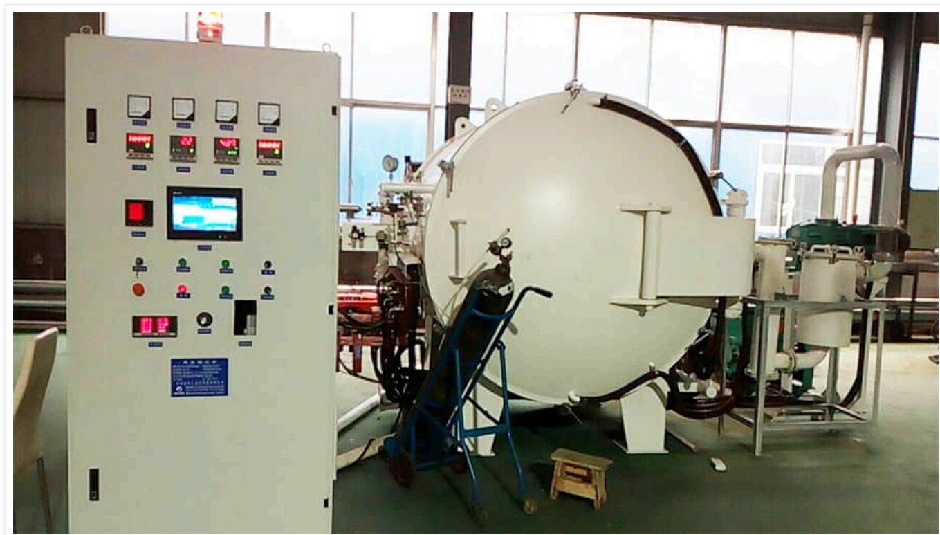
图：远航工业炉-高温陶瓷真空烧结/煅烧系统
