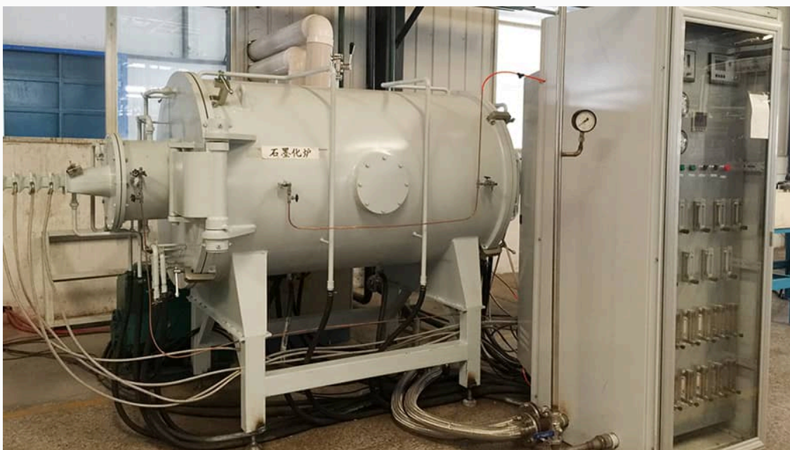
株洲远航工业炉科技有限公司 - 锂电池负极高温石墨化炉设备实物图
