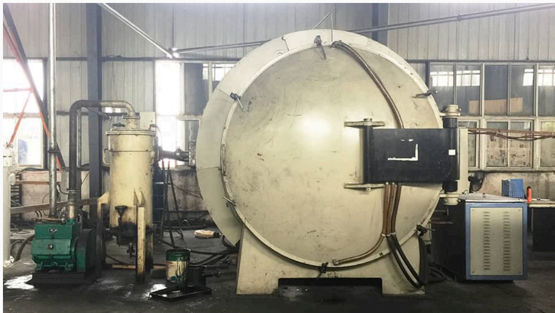
株洲远航工业炉科技有限公司 - 碳毡\保温毡碳化炉设备实物图
