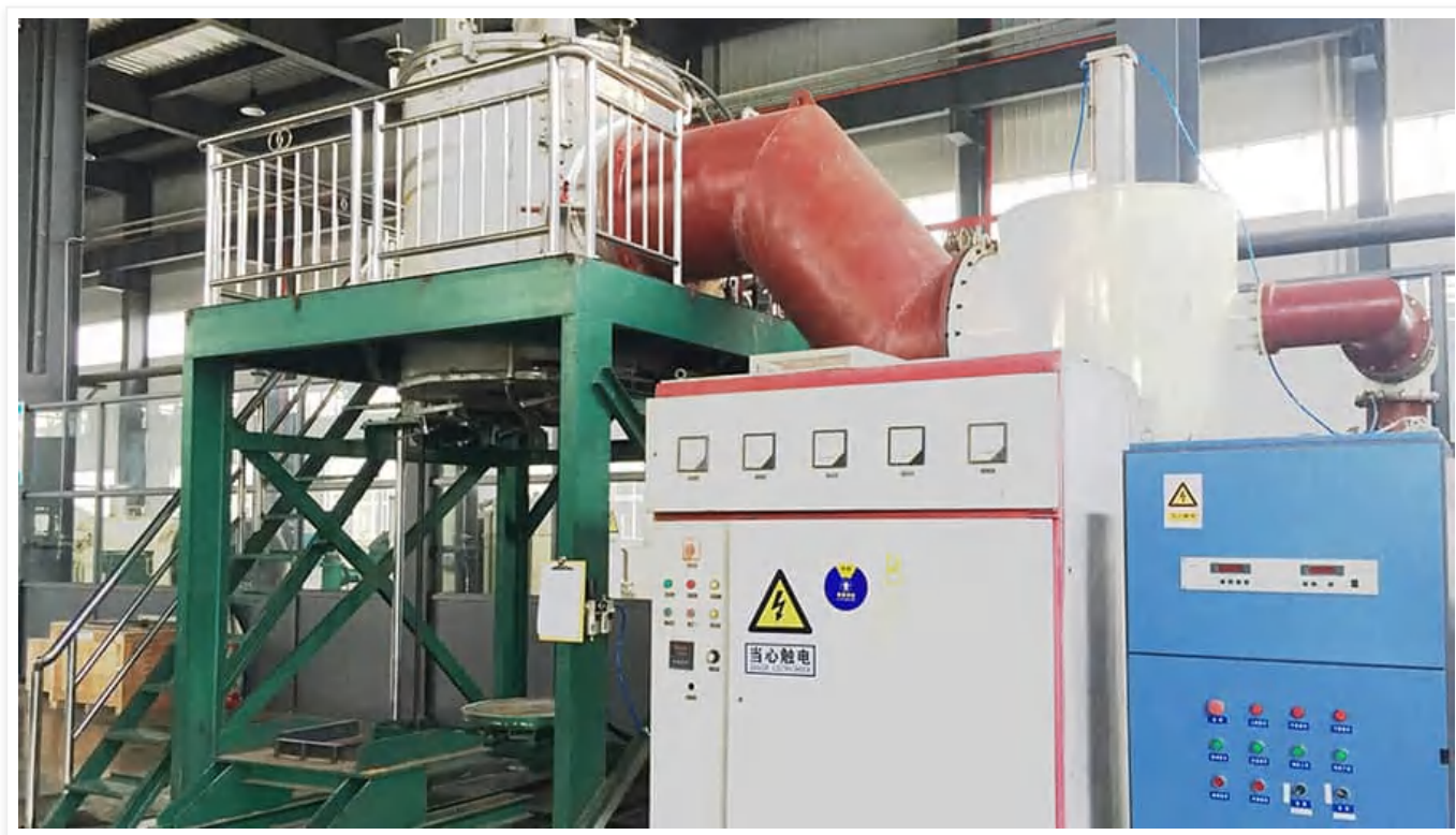
图：远航工业炉-2400°C级碳化钨感应加热系统
