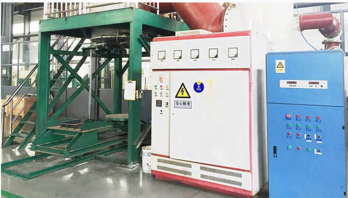
株洲远航工业炉科技有限公司 - 真空烧结脱脂一体炉设备实物图
