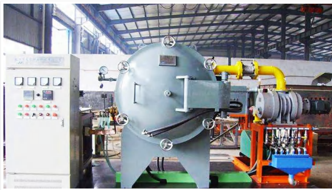
图：远航工业炉-真空中频感应烧结系统（支持2500°C超高温）
