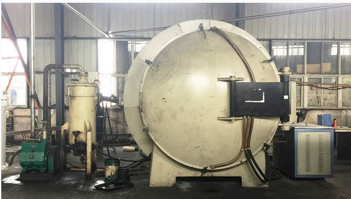
株洲远航工业炉科技有限公司 - 真空烧结炉设备实物图
